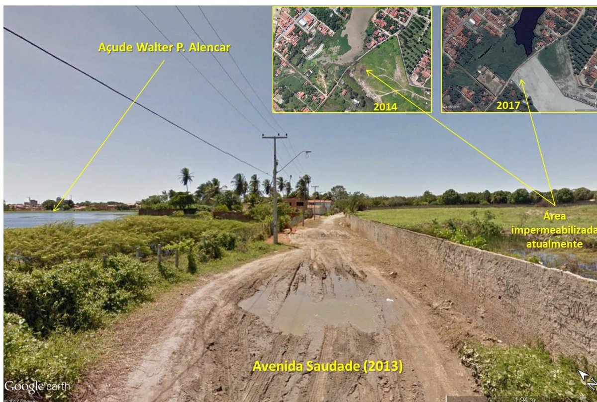
Figura 23 – Indícios de nível de água próximo da superfície (trecho da Av. da Saudade)
